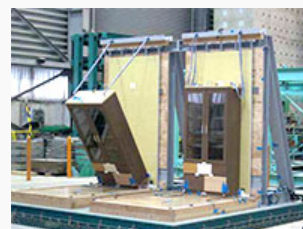
振動台実験の様子 協力：東急建設（株）技術研究所
