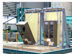
振動台実験の様子
