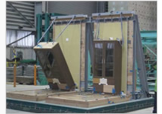
振動台実験の様子
